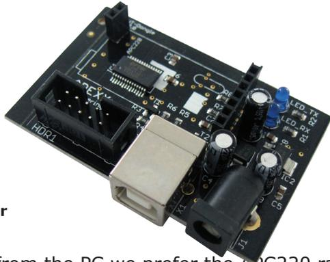
**Fig. 10 : RP6v2 USB Programmer (WT Dongle)**
