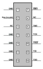
Figure 1-3. J1 Pinout
