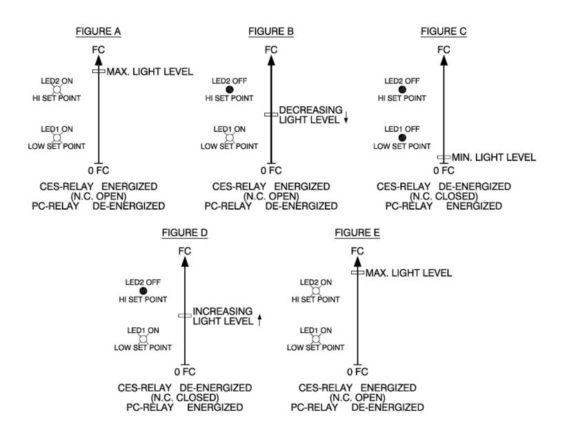
FIGURE 3: LC8 OPERATION SEQUENCE USING CES SENSOR (REVERSE OPERATION SEQUENCE USING PC SENSOR)
