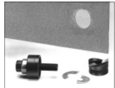
**8** Desarmar el perforador girando el husillo extractor en sentido contrario a las agujas del reloj mientras sostiene el perforador. Inclinar el cuño y dejar caer los pedazos recortados.
