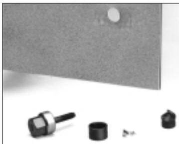
**5** Desarmar el perforador girando el husillo extractor en sentido contrario a las agujas del reloj mientras sostiene el perforador. Inclinar el cuño y dejar caer los pedazos recortados.
