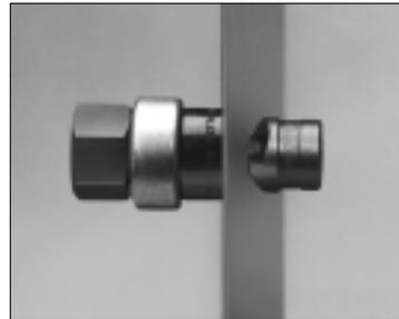
**3** Enroscar el perforador en el husillo extractor con el filo de corte hacia el material que se está perforando.
