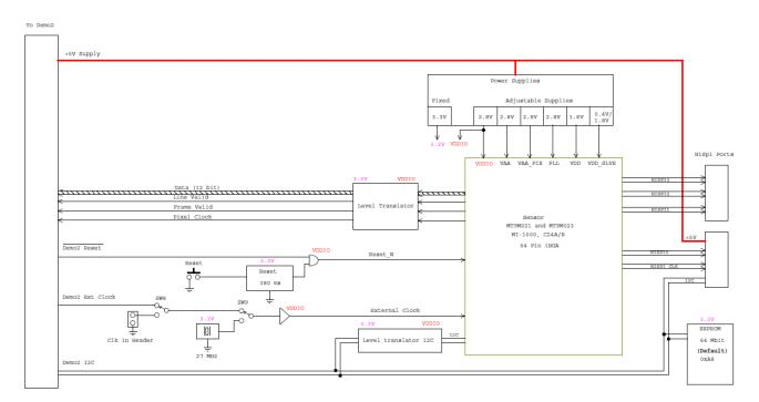
Figure 2. Block Diagram of MT9M021IA3XTMZH-GEVB
