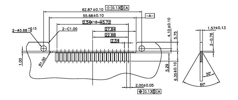
RECOMMENDED PC BOARD LAYOUT FOR CONNECTOR SOLDER TAILS
